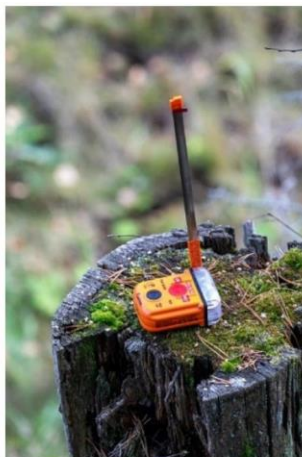
Coloque o PLB em uma superfície plana
