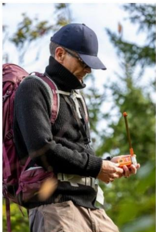
Certifique-se de desdobrar a antena antes da ativação
